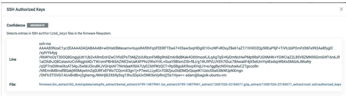
Abbildung 72: In der Firmware gefundener öffentlicher SSH-Schlüssel
